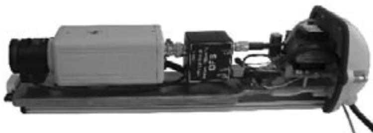
Требуется внутреннее свободное пространство в термокожухе (объектив + камера + передатчик + оптический разъем) не менее 270 мм.
